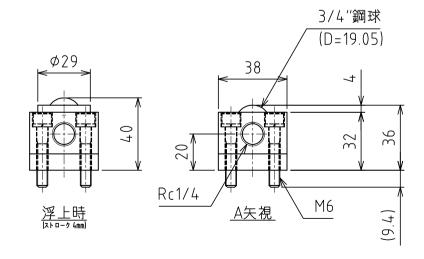
負荷能力 3.72kN(379.3kgf)/ユニット 0.31kN(31.6kgf)/フリーベア 1個 ※使用空気圧 0.50MPa (5.1kgf/cm²)
