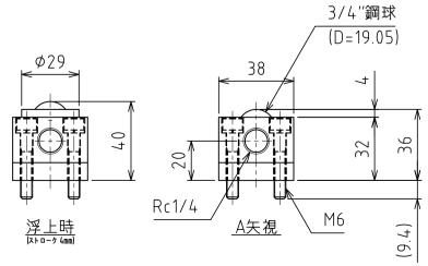
負荷能力 1.86kN(189.7kgf)/ユニット 0.31kN(31.6kgf)/フリーベア1個 ※使用空気圧 0.50MPa (5.1kgf/cm²)
