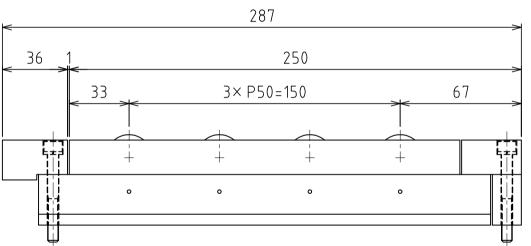
負荷能力 5.12kN(522.1kgf)/ユニット 1.28kN(130.5kgf)/フリーベア1個 ※使用空気圧 0.50MPa (5.1kgf/cm²)
