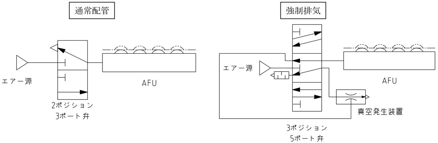
※本製品のフリーベア部は、下降動作時、エアース排気してもシリンダーのOリングの抵抗等により自然に下降しません。(残圧は抜けているため、搬送物の自重等の負荷により下降します。)フリーベアを強制的に下降させる場合は、「強制排気」回路を参照してください。
