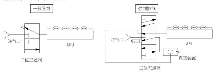
※本产品的 Freebear 在下降动作时,即使排放空气,由于气缸的 O 型环等的阻力,并不会自然下降。(因为残压已经排出,因此会在搬运物的自重等负荷下下降。)若要强制使 Freebear 下降,请参照「强制排气」回路。
